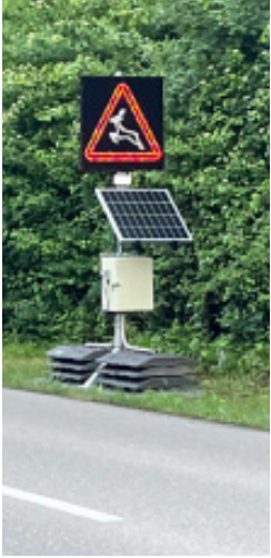
Der Prototyp ist seit Mai im Einsatz. Die Anlage leuchtet während den Stunden, in denen das Risiko für einen Unfall besonders hoch ist auf, sobald sich ein Fahrzeug nähert.
